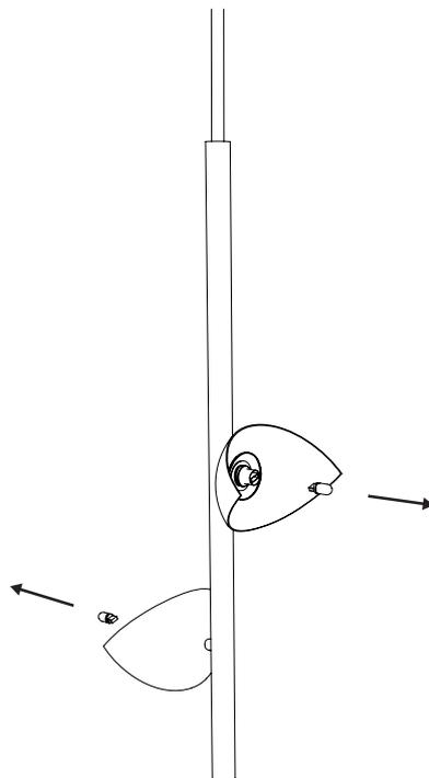
Remplacer les ampoules en les tirant.
